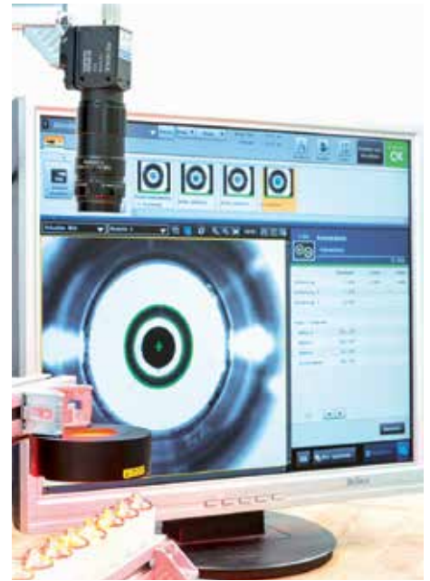
Eine optische Inspektion stellt die Präzision hinsichtlich Bohrungsdurchmessern und Konzentrität sicher.
